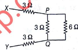
परिणामी प्रतिरोध  $r_2$ ;  $\frac{1}{r_2} = \frac{1}{3} + \frac{1}{6} = \frac{3}{6} \Rightarrow r_2 = 2 \text{ ओम}$
